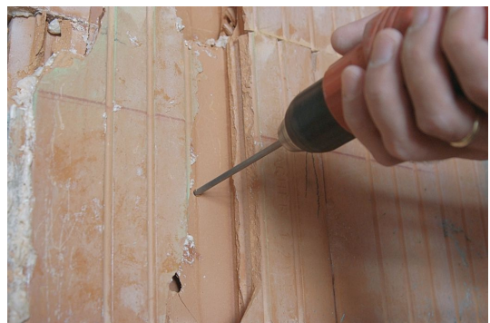
Der LB Lanzenbohrer ist ideal auch für Fliesen und Keramik.
