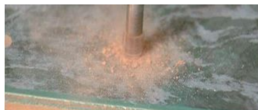
Der LB Lanzenbohrer ist ideal auch für Fliesen und Keramik.
